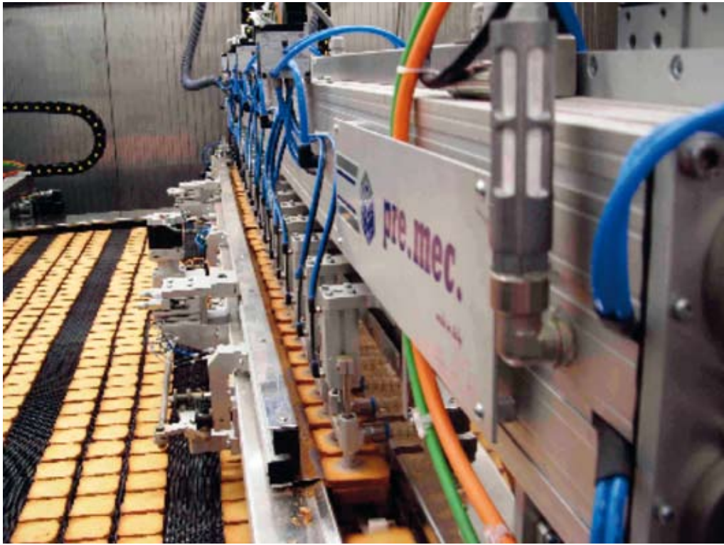
Particolare del secondo portale, dove la prima fetta della coppia viene rilasciata sul piano d'attesa (Pre.Mec.).
