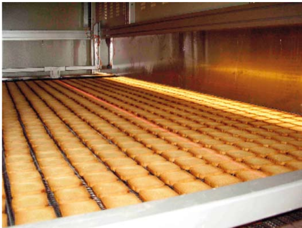
Stazione di visione a raggio laser dei ranghi di prodotto che trasmette i dati al portale per il prelievo (Pre. Mec.).
